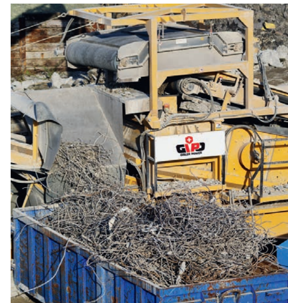
Eisenaustrag in Flussrichtung mittels sehr starkem Permanentmagnet
