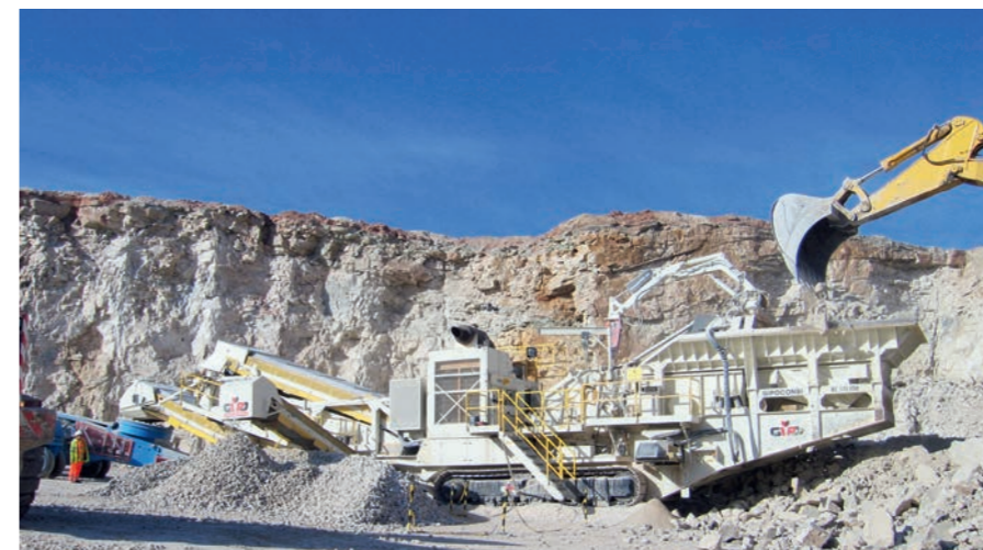
RC 170 FDR mit einer Leistung bis 1'100 t/h
