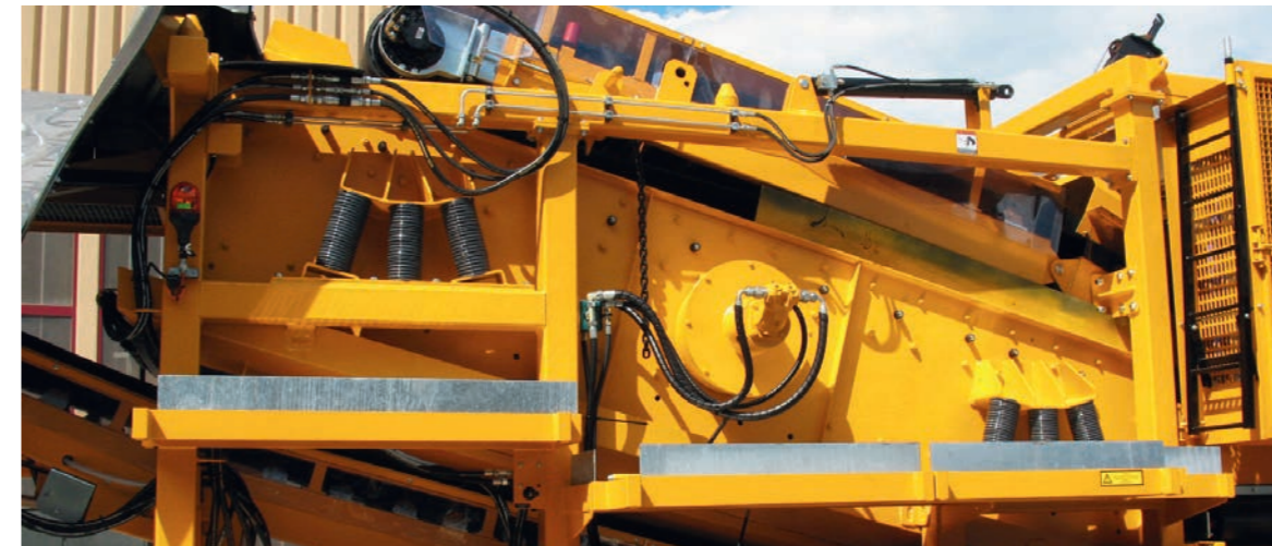
Bis 3-Deck Siebmaschine auf gleichem Chassis wie Brecheinheit
