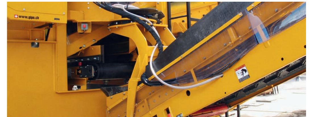
Überkornrückführband hydraulisch schwenkbar für Haldenaustrag
