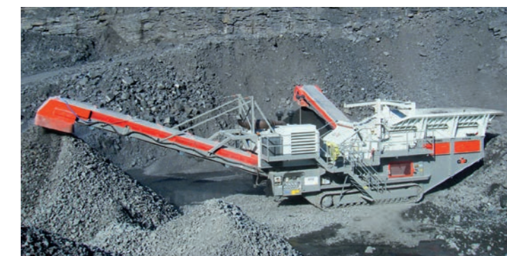
R 170 FDR mit einer Leistung bis 1'100 t/h
