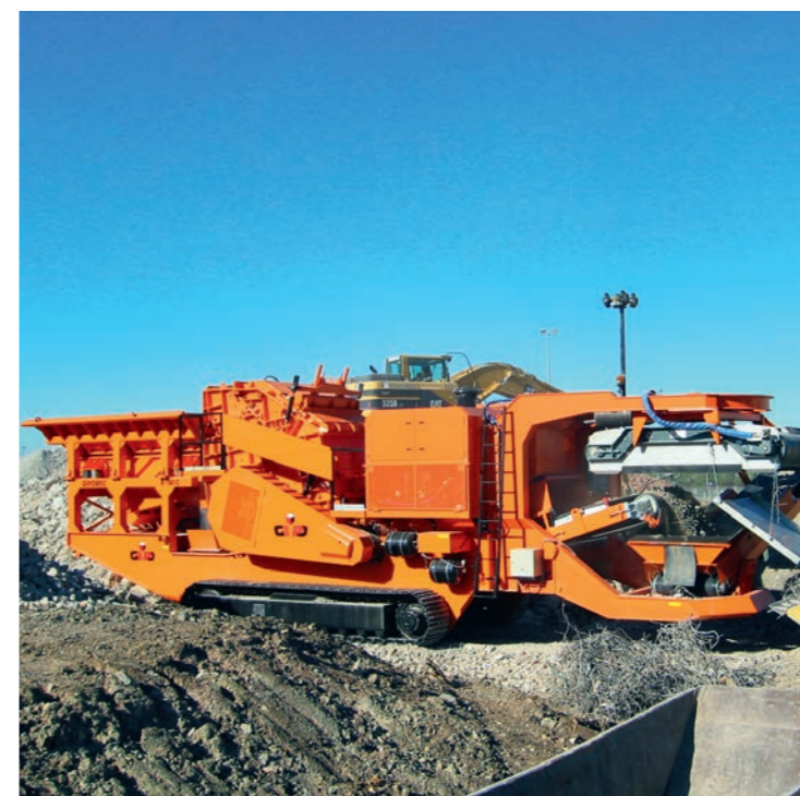
R 150 C brechen von Bahnschwellen mit langer Federstahlarmerung
