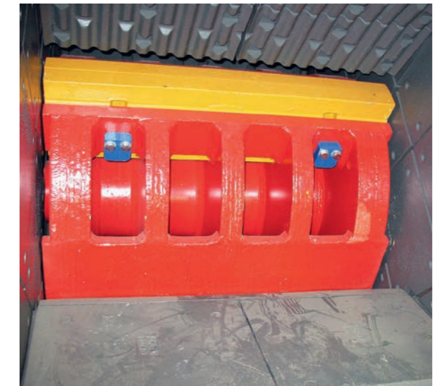
Robuste Bauweise von Rotor und Lagerung mit sehr hohem Drehmoment
